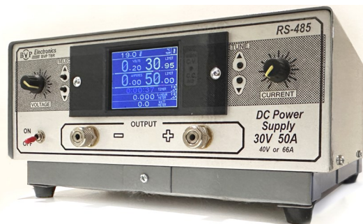
Мал. 1. Імпульсне джерело живлення постійного струму BVP TBR 30V 50A
