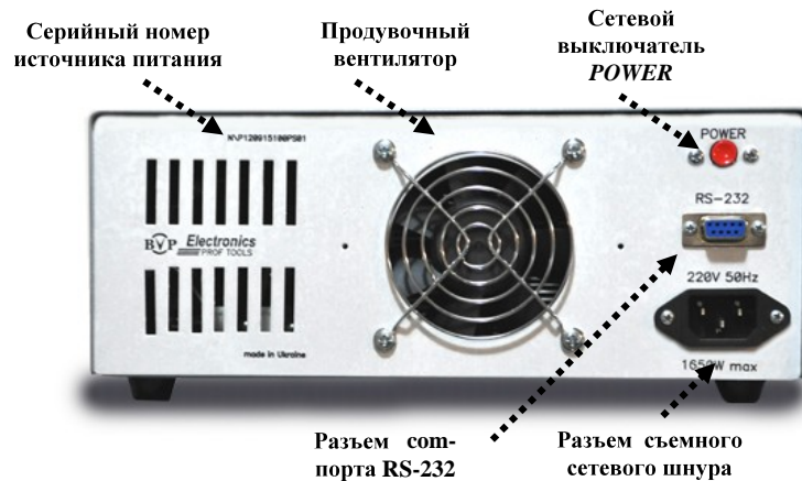
Рис. 4 Расположение органов управления на задней панели головного модуля источника питания
