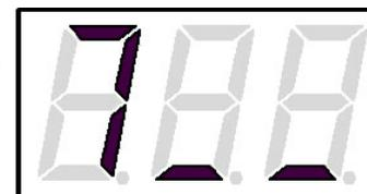
Рис. 9. Символ таймера (дозатора) с отключением тока
