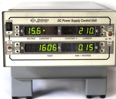
Рис. 1. Трехфазный импульсный выпрямитель
