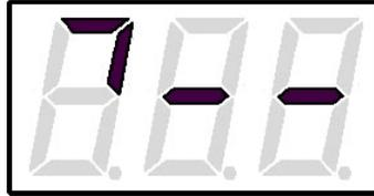
Рис. 10. Символ таймера (дозатора) снижения лимита тока до 10%
