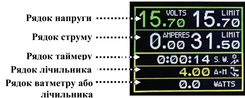
Мал. 3. Відображення інформації на дисплеї джерела живлення
