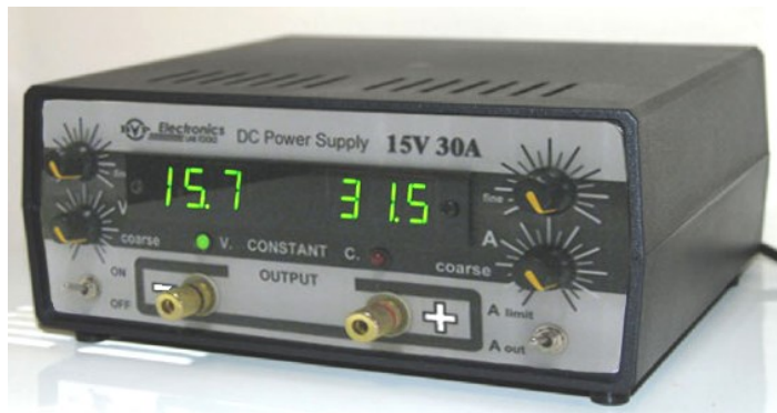
Рис. 1. Импульсный источник питания постоянного тока Lab Tools 15V 30A
