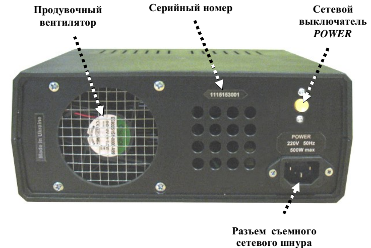
Рис. 3. Расположение органов управления на задней панели источника питания
