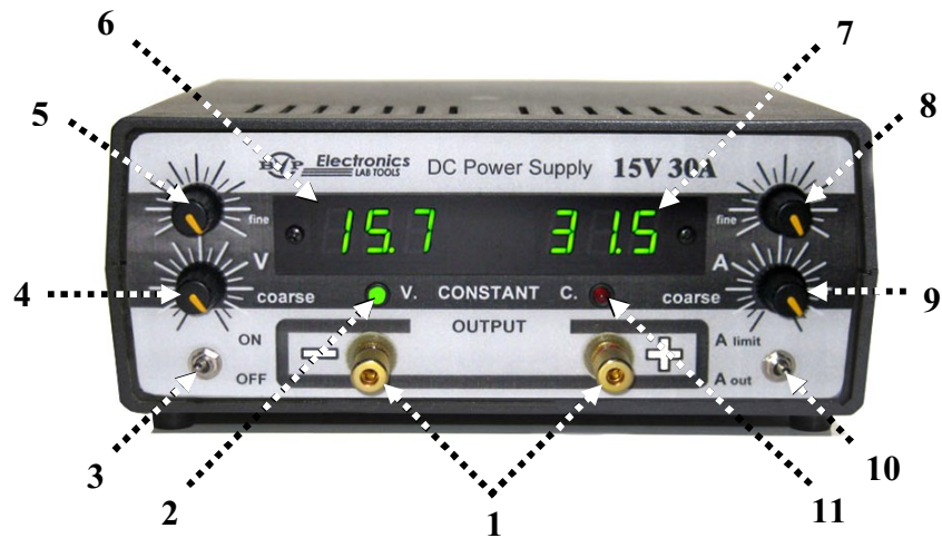
Рис. 2. Расположение органов управления на передней панели источника питания
