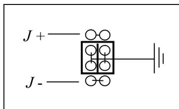
Рис. 7 Снятие заземления с выходных клемм источника
