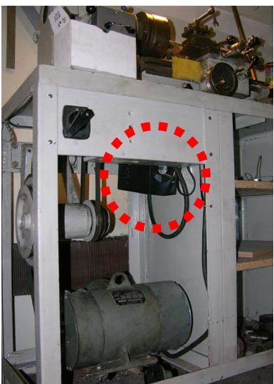
Усилием наших разработчиков, механиков и конструкторов для собственных нужд модернизирован токарный станок ТВШ-16. Для него разработан и создан уникальный блок питания с регулировкой выходных параметров от 1 до 300В и от 0 до 5А.
