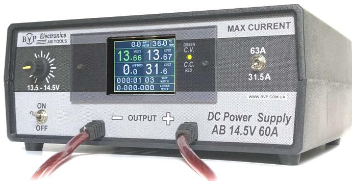
Рис. 1. Импульсный источник питания постоянного тока для работы с аккумуляторными батареями VVP AB 14.5V 60A
