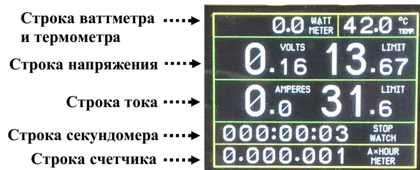
Рис. 3. Отображение информации на дисплее источника питания
