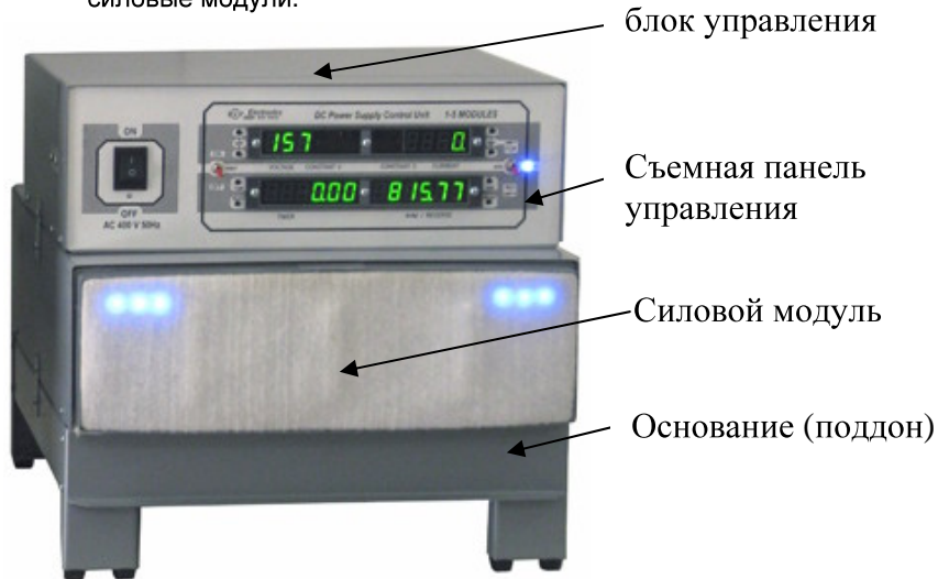
Рис. 2. Составные части выпрямителя
