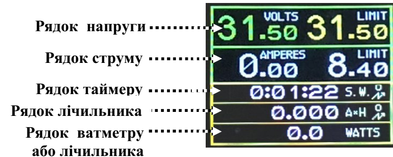
Мал. 3. Відображення інформації на дисплеї джерела живлення
