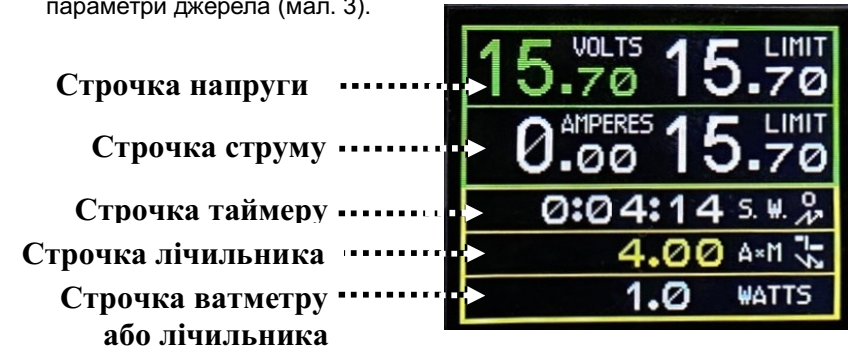
Мал. 3. Відображення інформації на дисплеї джерела живлення
